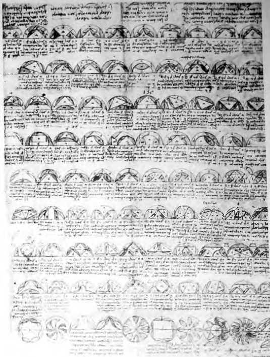
Ilustração 9-33a. Proporções de engrenagens de Leonardo aplicadas aos seus inventos. (De The Unknown Leonardo , p. 78.)
